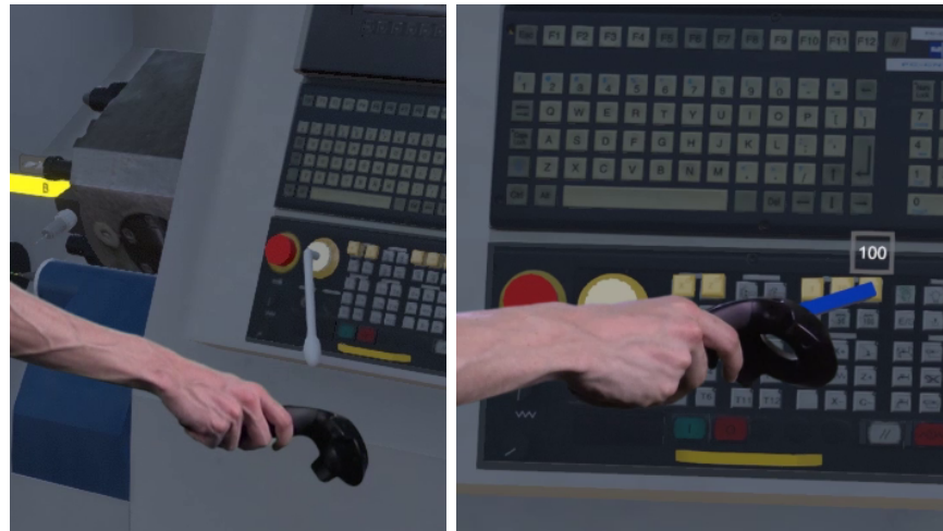
FIGURE 4.8 – Modifications contextuelles de la main virtuelle : dans l'image de gauche en bâton au contact d'un bouton (appui); dans celle de droite en clé Allen au contact d'une molette (rotation).
