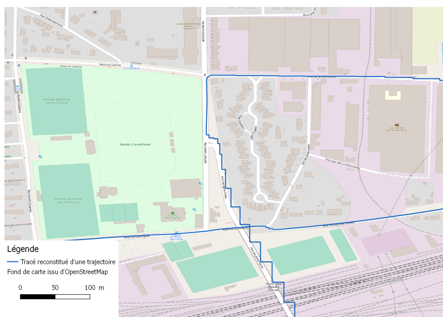
FIGURE 4.8 – Illustration de l'effet de crénelage sur les données émises par le système
