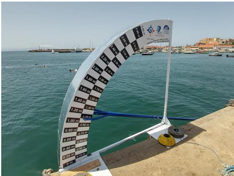
Figure 30 : Installation de l'échelle de marée circulaire au port de Tamentfoust
