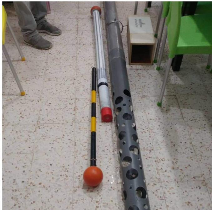
**Figure 27 : Echelle de marée rotative (RTG)**
