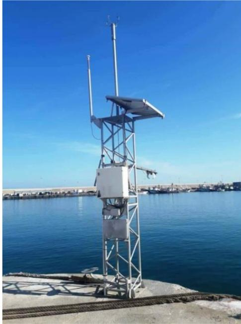
Figure 26 : Marégraphe à capteur ultrason (LOG\_aLevel ULL6080)
