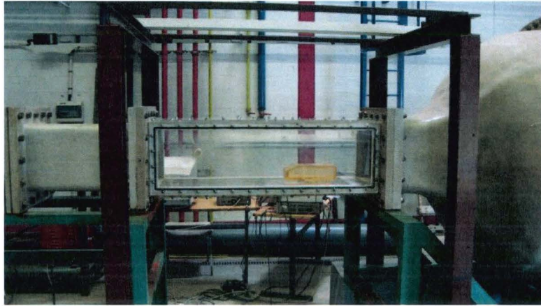
Figure 2.1 – Veine d'essai du canal hydrodynamique polarographique avec maquette.
