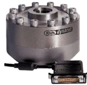
(c) Capteur de force *Instron Dynacell Serie 2527*.
