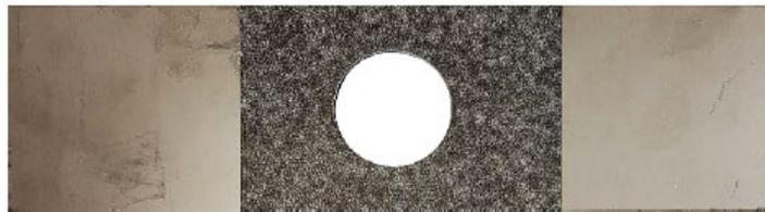
**Figure 5.1** – Photographie de face de l'éprouvette trouée et de son mouchetis.
