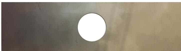
**Figure 7.4** – Photographie de l'éprouvette d'acier « 316L » utilisée.
