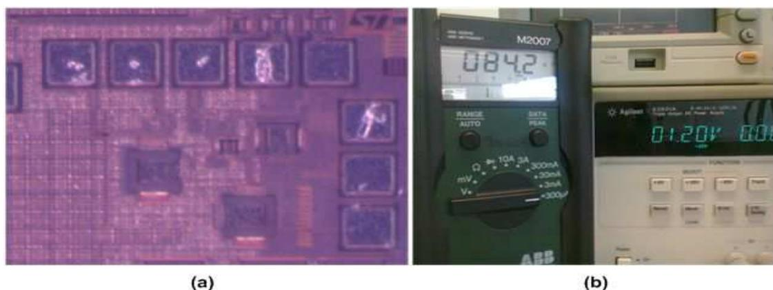
Figure II.47. (a) Vue chip et (b) Consommation du module CDR 54 MHz
