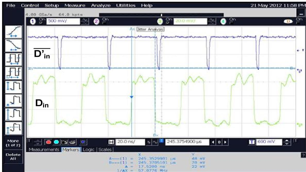
Figure II.46. Elargissement d'impulsions de largeur 2 ns. La représentation du signal d'entrée (en jaune) est complétée
