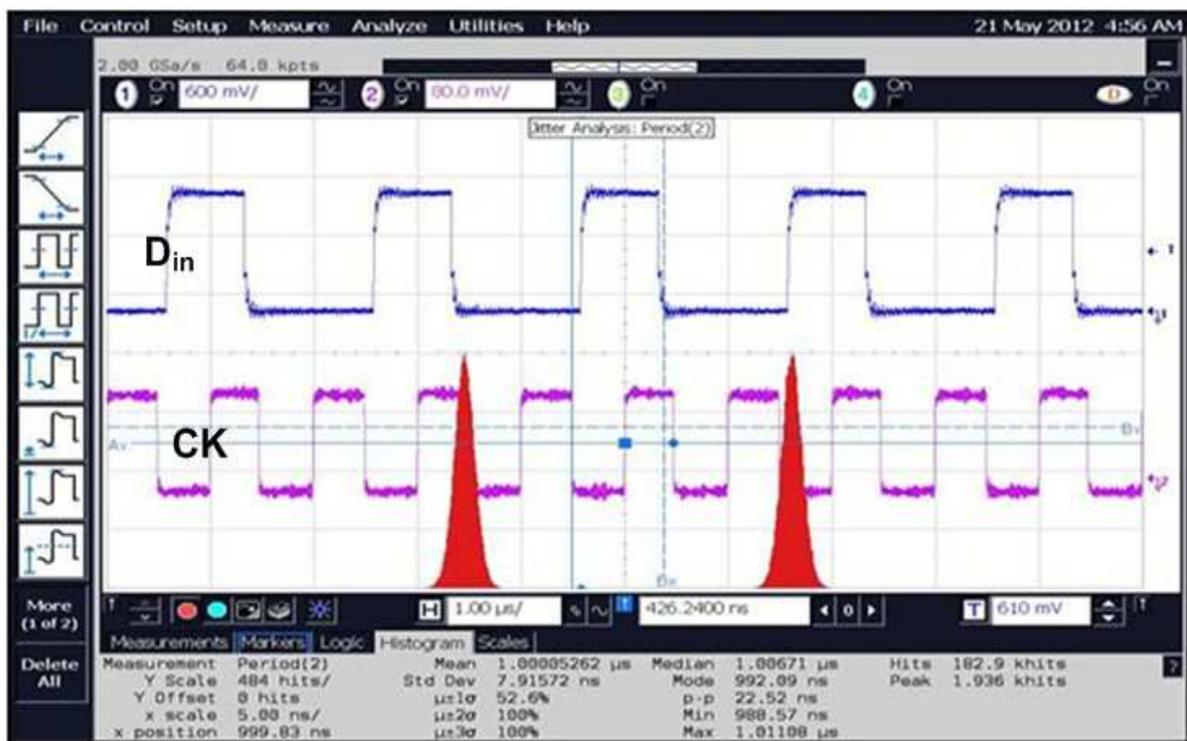
Figure II.51. Boucle 1 MHz verrouillée : impulsions en entrée (pattern 0101...) et horloge de sortie (signal temporel + histogramme sur la période d'horloge)
