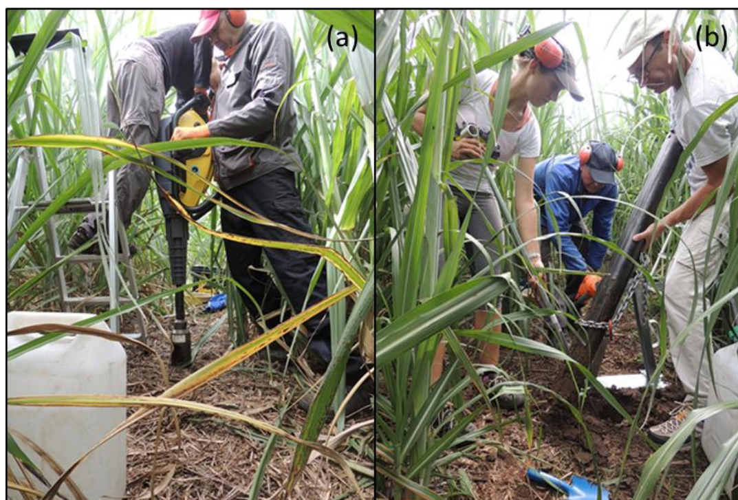
FIGURE 2.20 : PRELEVEMENT D'UNE CAROTTE DE SOL SOUS CANNE A SUCRE EN 2016 : UTILISATION DU CAROTTIER MOTORISE A PERCUSSION POUR PRELEVER LA CAROTTE DE SOL (A) ET EXTRACTION DE LA CAROTTE DE SOL (GOUGE DE 1M) PAR UN DISPOSITIF DE LEVIER (B)
