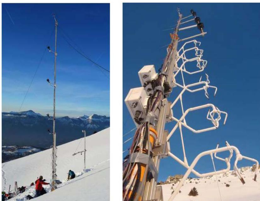
Figure 4.2 : photographies des deux mâts de mesures installés sur la face ouest du Grand Colon, février 2019 (d'après le rapport de stage de Claudio Pierard).
