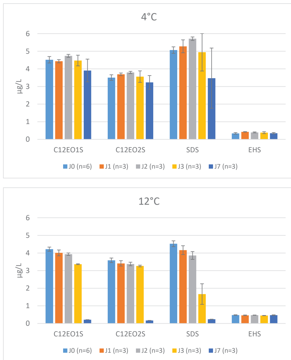
Figure 61: Suivi de la concentration des alkyl et alkyl éther sulfates à 4 et 12°C, sur 7 jours
