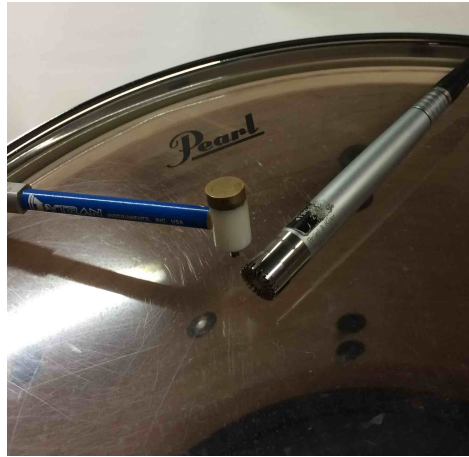
FIGURE 10.16 – Dispositif d'accordage de la membrane : marteau d'impact et microphone
