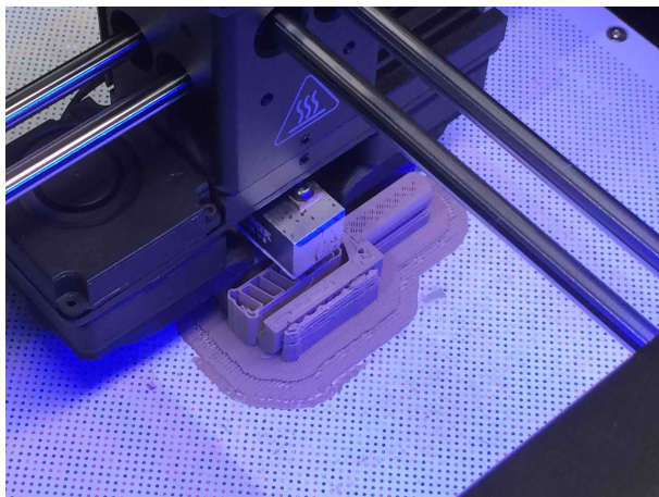
FIGURE D.4 – Impression 3D de la pièce d’ajustement de diamètre
