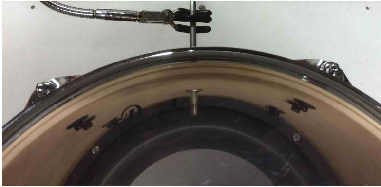
FIGURE 10.35 – Dispositif de contrôle : microphone dans la cavité comme capteur de pression. (Dans cette photo, un autre modèle de microphone est monté à titre indicatif.)
