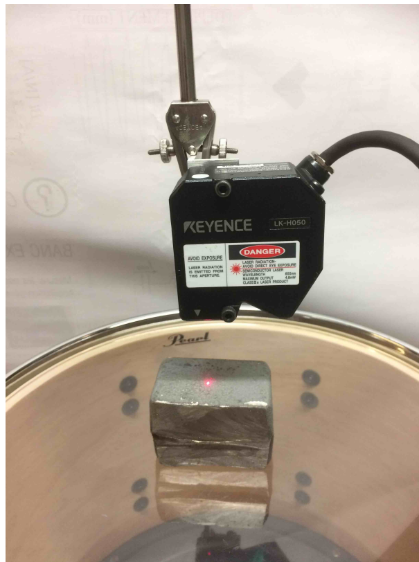
FIGURE 10.20 – Dispositif d’identification de la tension de la membrane (méthode mécanique) : le laser et le poids sur la membrane
