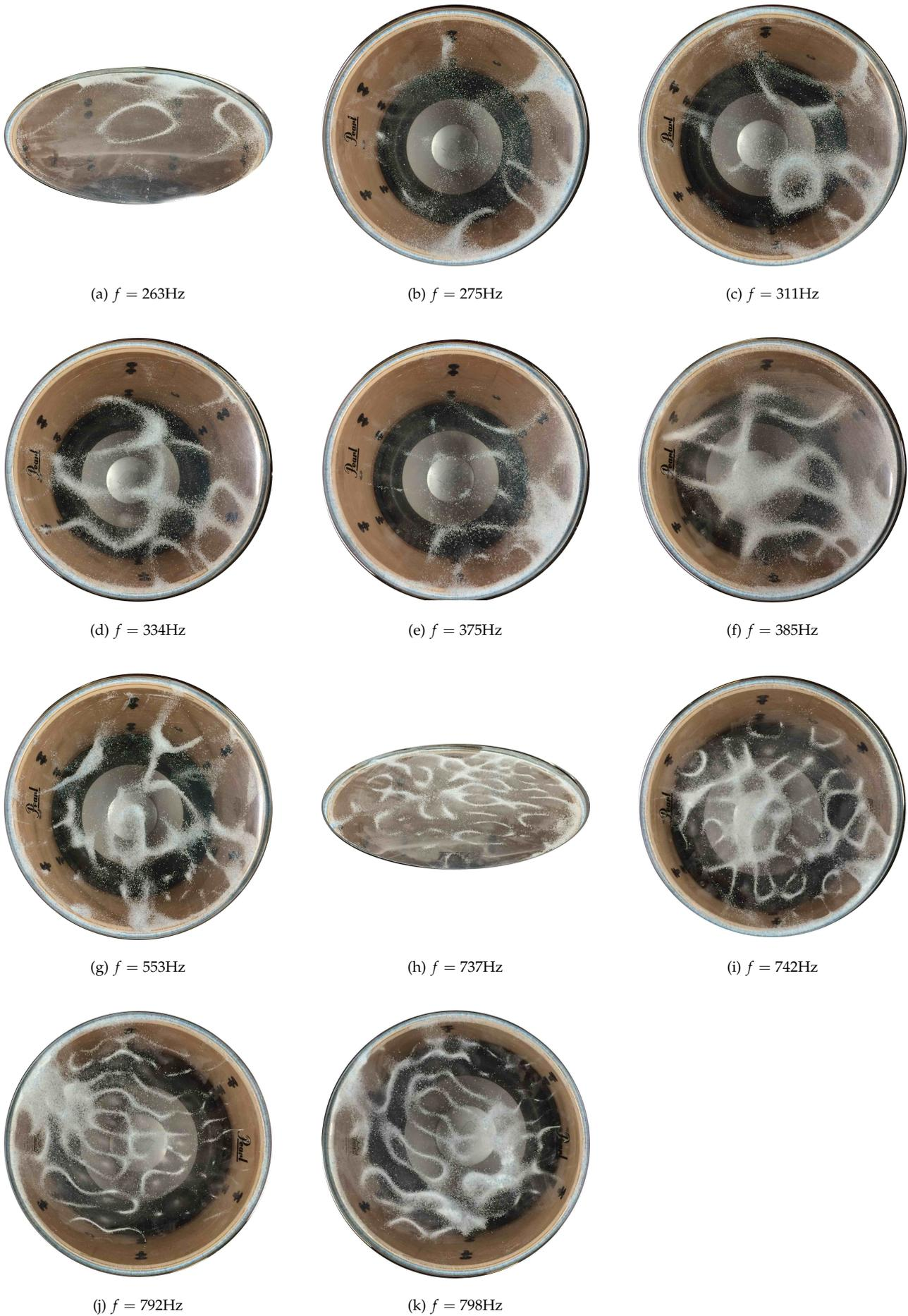
FIGURE D.1 – Figures de Chladni de quelques modes plus élevés. La fréquence d'excitation est indiquée.
