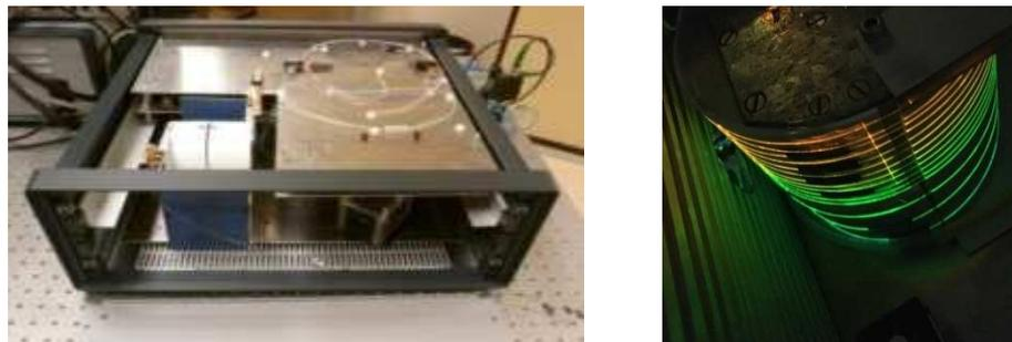
Figure 32 – Gauche : amplificateur fibré dopé Thulium à 2.05 $\mu\text{m}$ , réalisé et intégré sous forme de rack au laboratoire (Source : E. Lucas, Onera) ; Droite : Fibre enroulée à laquelle on applique une contrainte mécanique distribuée longitudinalement, dans le but de diminuer le gain Brillouin et ainsi augmenter la puissance crête tolérée dans la fibre optique (Source : G. Canat, Onera).
