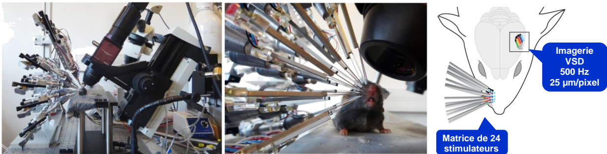
Figure 15. Poste expérimental combinant imagerie sensible au potentiel et matrice de stimulation multi-vibrissale.
