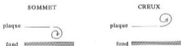
figure 5.11: formation des tourbillons sur le bord aval de la plaque, au passage du sommet et du creux de la vague
