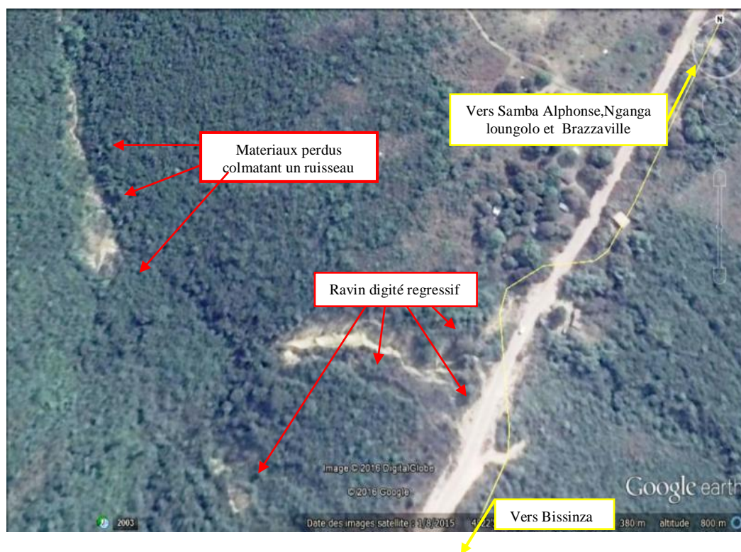
Image satellitale 2 : Sédimentation d'un ruisseau à Touboula et menace de coupure de la route par le ravin digité régressif à Touboula, sur l'axe de Linzolo
