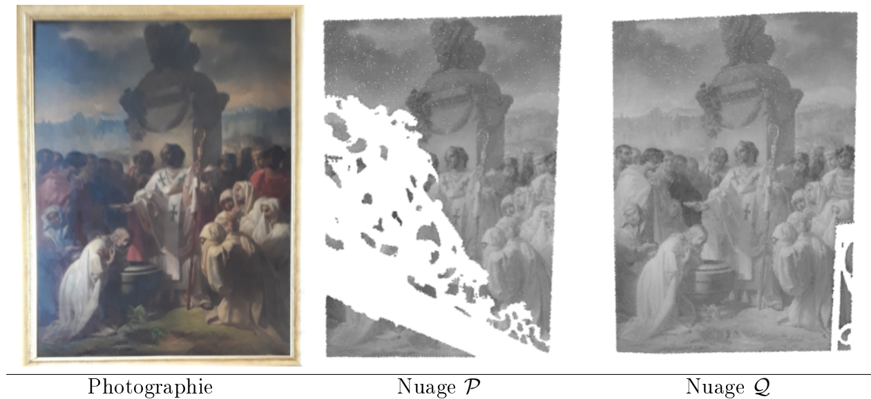
Fig. IV.3.3. Photographie et nuages de points d'un tableau numérisé sans le cadre. Les tonalités en degrés de gris correspondent à l'intensité brute issue du LiDAR. Nuages de points issus du projet E-Cathedrale.
