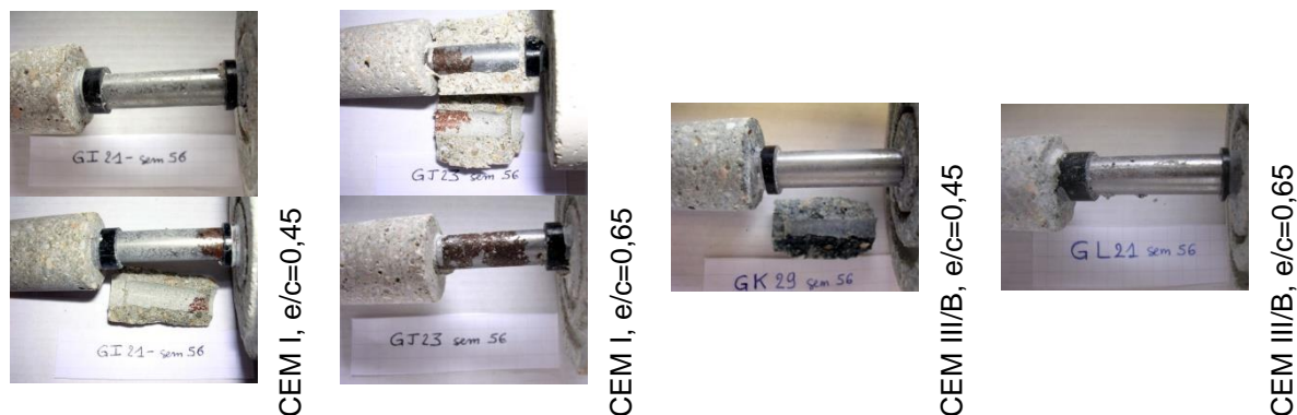
Figure III-8: Observation visuelle de l'état de corrosion de l'acier après 56 semaines [7]
