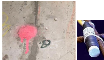
Sonde de référence noyée Mn/MnO 2 (ERE 20, Force Technology)
