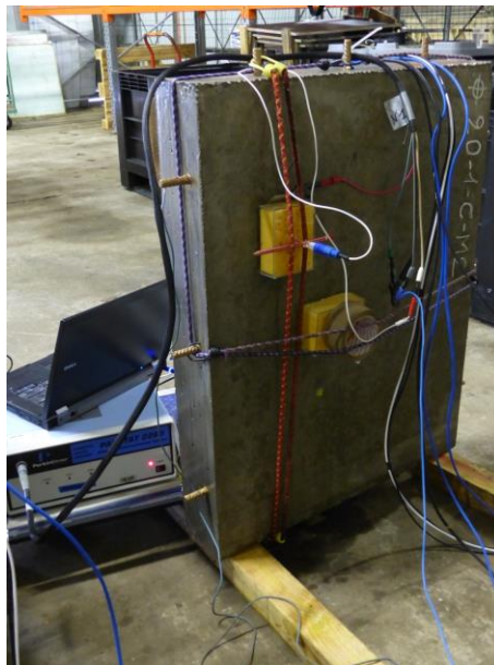
Figure V-7 : Mesures électrochimiques de corrosion réalisées sur le parement d'une dalle en béton armé avec des ions chlorure (crédit photo: V. Bouteiller, Ifsttar).
