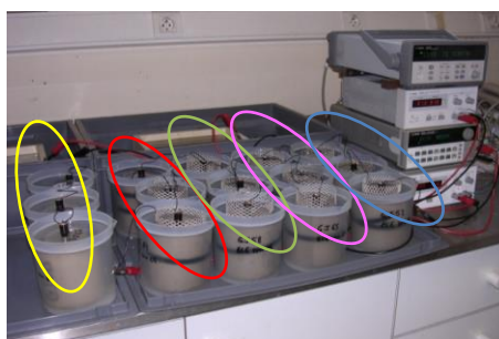
Figure IV-4 : Déchloration de mortiers armés en fonction de la durée du traitement (les couleurs jaune, rouge, vert, magenta et bleu correspondent respectivement à 0 (témoin), 2, 4, 6 et 8 semaines). [Rapport DRAST, 2005].
