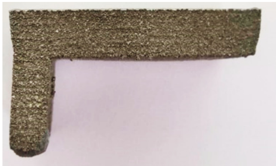
FIGURE 4.6 – Plongeur après enlèvement des supports
