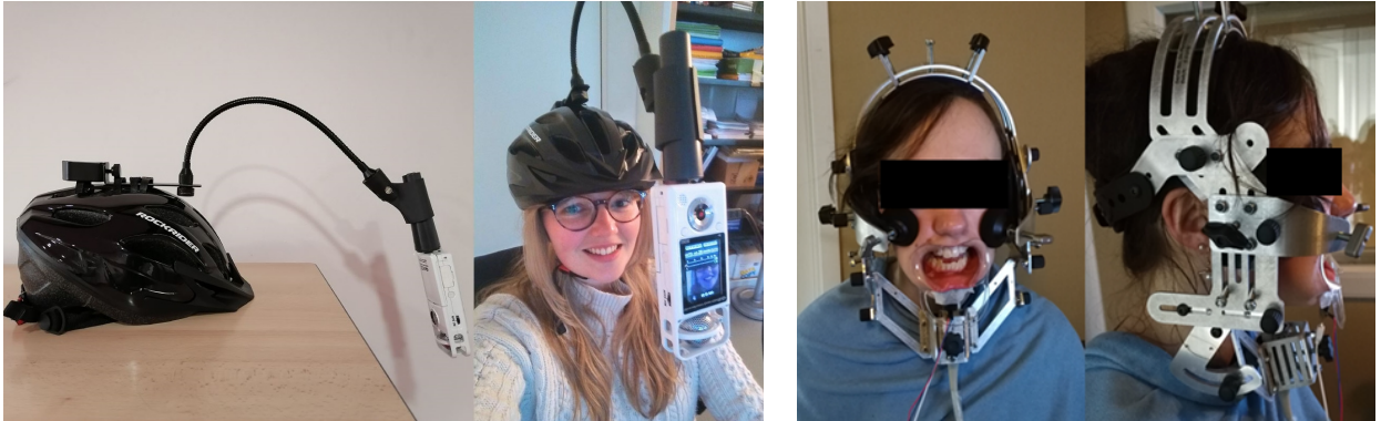
FIGURE 3.10 – À gauche : système d'acquisition audio-visuel « fait maison » porté par Hannah King. À droite : dispositif articulatoire combinant un « écarteur de lèvres », un accéléromètre et une sonde échographique maintenue par un casque.
