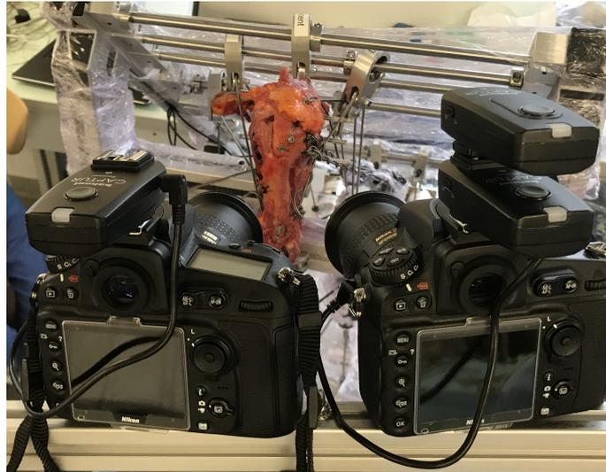
Figure 4.13 – Banc de stéréo-corrélation d'images.
