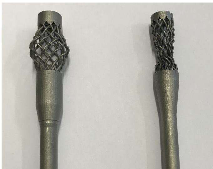
Figure 3.14 – Echantillons de treillis filaire avec interférences après compression et torsion.
