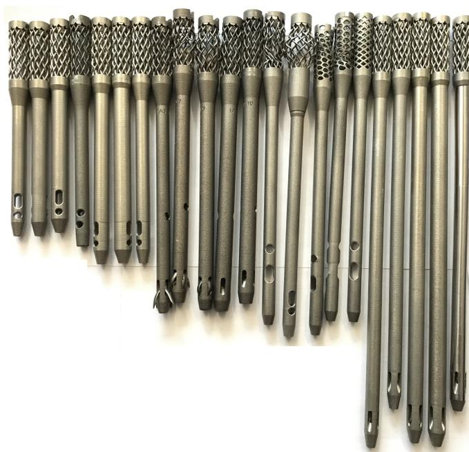
Figure 4.1 – Des exemples de clous réalisés pour les essais cadavériques par fabrication additive.
