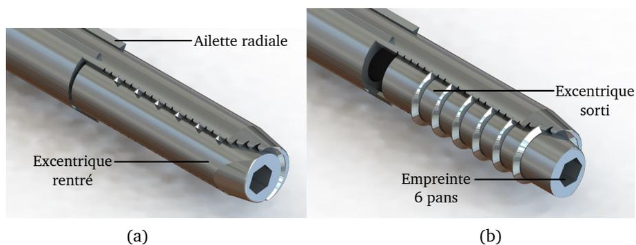
Figure 3.24 – Solution de fixation par excentrique fileté.
