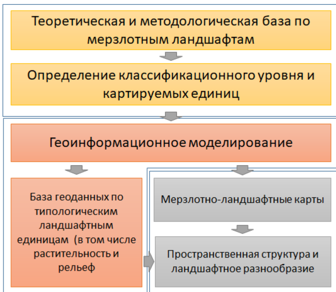
Рисунок 12. Концептуальная модель изучения пространственной структуры мерзлотных ландшафтов по геоинформационному моделированию
