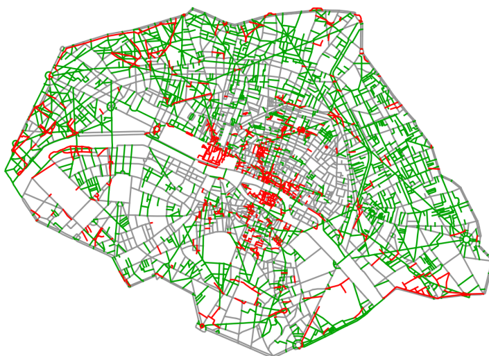
Figure 3.5: Exemple de requête temporelle sur un STAG de Paris (d'après Benoît Costes [Cos16]) : en vert les créations, en rouge les disparitions et en gris les entités stables.
