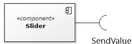
Figure 1.2 – Représentation en UML 2.0 du composant Slider avec un service requis SendValue
