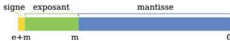
FIGURE 2.4 – Stockage d'un nombre à virgule flottante en représentation binaire
