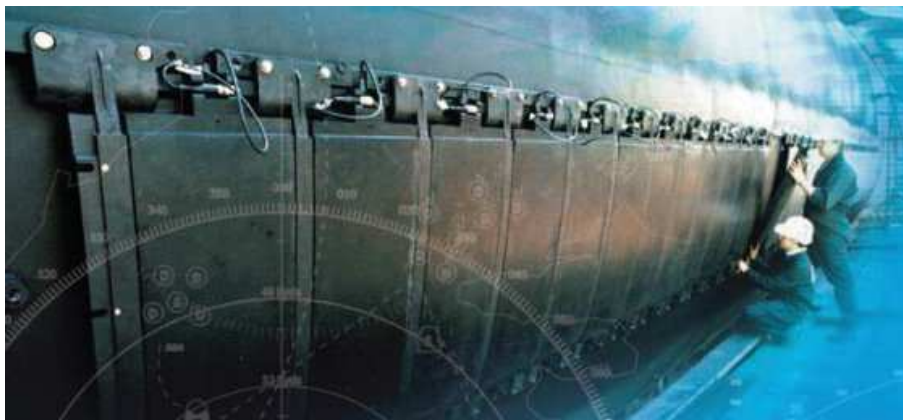
FIGURE 1 – Exemple d'une antenne de flanc intégrée à un véhicule sous-marin
