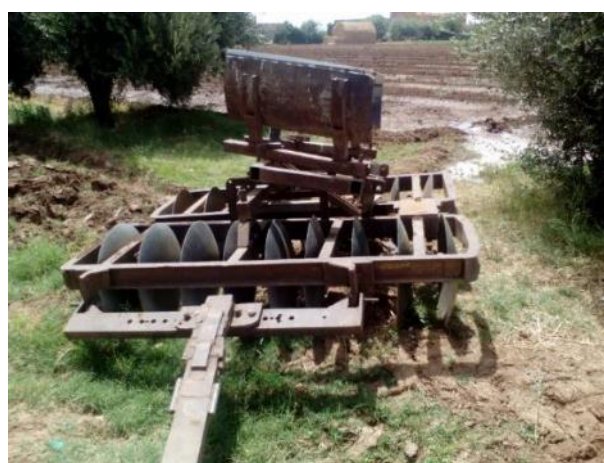
Photo 8.12 : Charrue à disque utilisé pour les travaux du sol superficiels. Cliché : R. BISSOUR 2016
