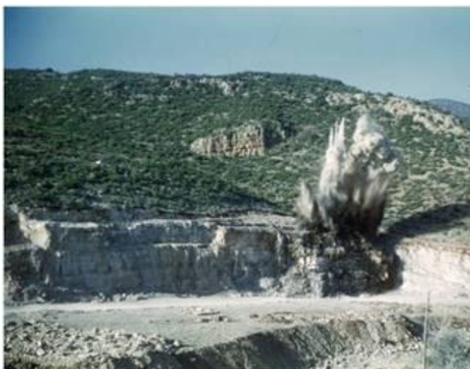
Photo 6.4 : L'utilisation des exploifs pour extraire des matériaux de construction. (Source : www.dafina.net )
