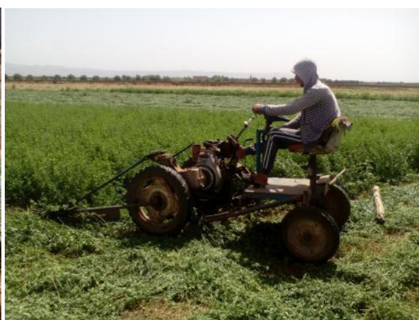
Photo 9.12 : exemple d'un matériel mécanique simple utilisé pour la fauche de la Luzerne. Cliché R. BISSOUR (2016)
