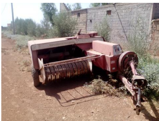
Photo 9.11 : ramasseuse-presse utilisée pour mettre les pailles en botte.
