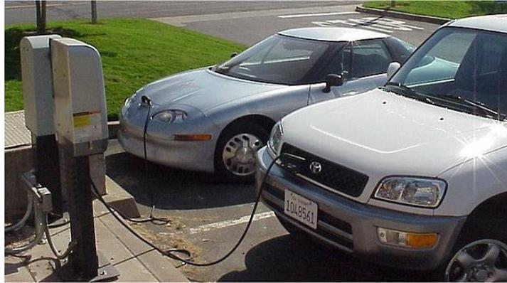
Figure I-8 : Chargeur « Magne Charge » [26]
