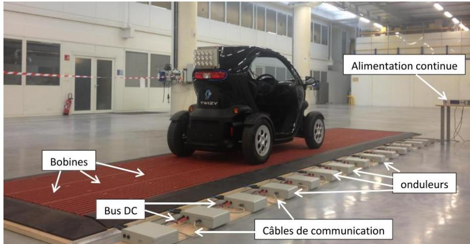
Figure I-15 : Système DWPT développé par Renault-Supélec [5].
