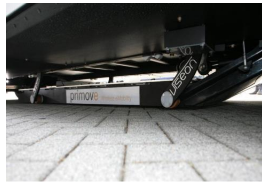
Figure I-11 : Secondaire du système Primove de Bombardier, a) secondaire en roulant, b) secondaire abaissé (recharge) [31]
