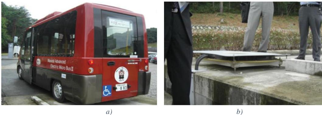
Figure I-9 : a) Waseda Electric bus, b) bobine primaire du système [25]
