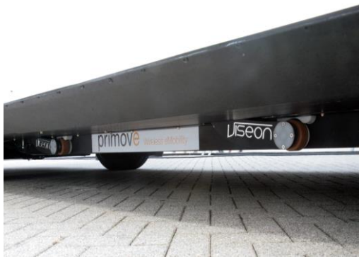
Figure I-11 : Secondaire du système Primove de Bombardier, a) secondaire en roulant, b) secondaire abaissé (recharge) [31]
