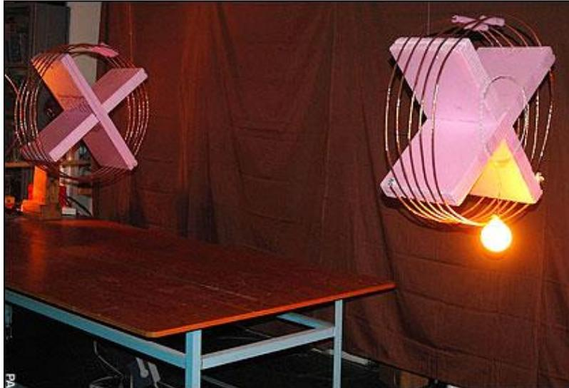
Figure I-1 : Alimentation sans contact d'une lampe - Witricity [12]
