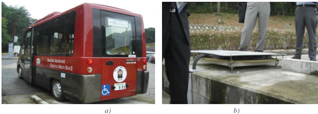
Figure I-9 : a) Waseda Electric bus, b) bobine primaire du système [25]
