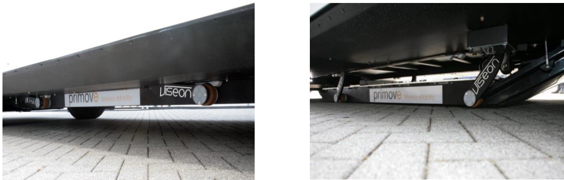
Figure I-11 : Secondaire du système Primove de Bombardier, a) secondaire en roulant, b) secondaire abaissé (recharge) [31]
