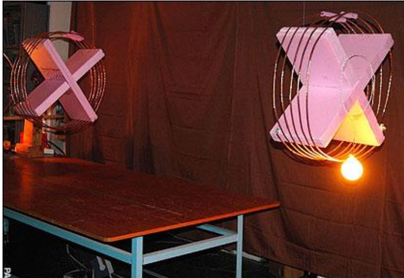
Figure I-1 : Alimentation sans contact d'une lampe - Witricity [12]
