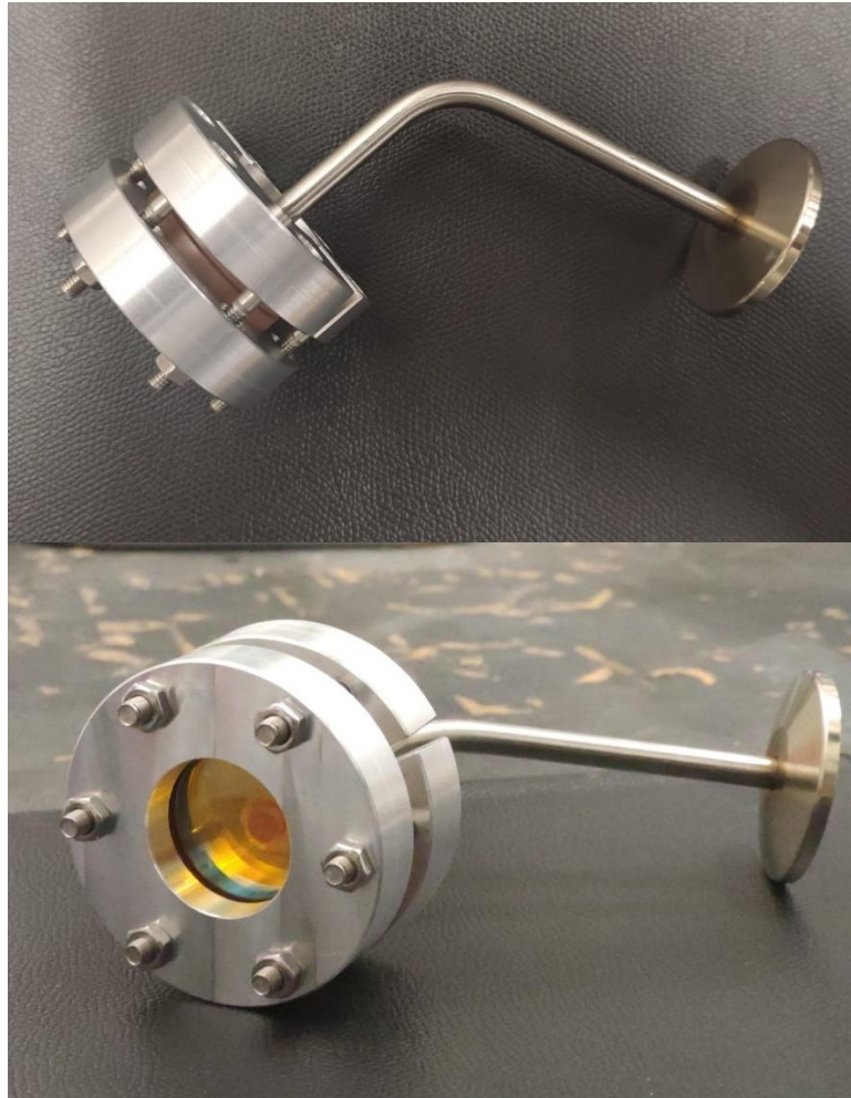
FIGURE 50 Cellule mince avec ses brides et un tuyau pour le passage du gaz. Les fenêtres sont aussi en ZnSe.
