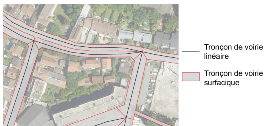
Figure 8-9 – Construction finale des tronçons surfaciques
