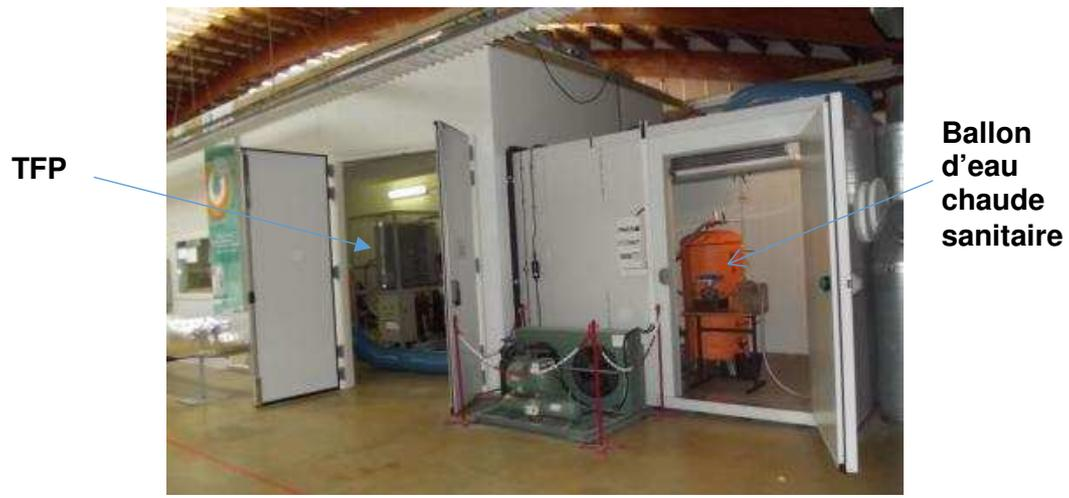
Figure 37 : Photographie d'implantation de la TFP dans les enceintes climatiques
