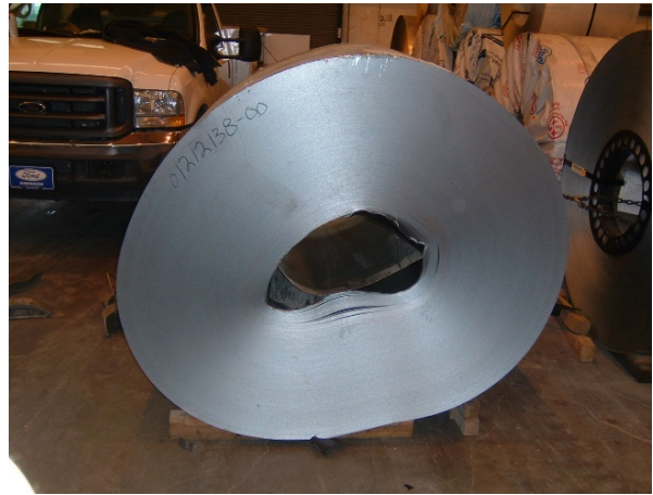
(b) Effondrement partiel.
