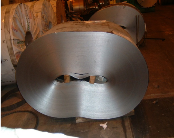
(a) Effondrement complet.
