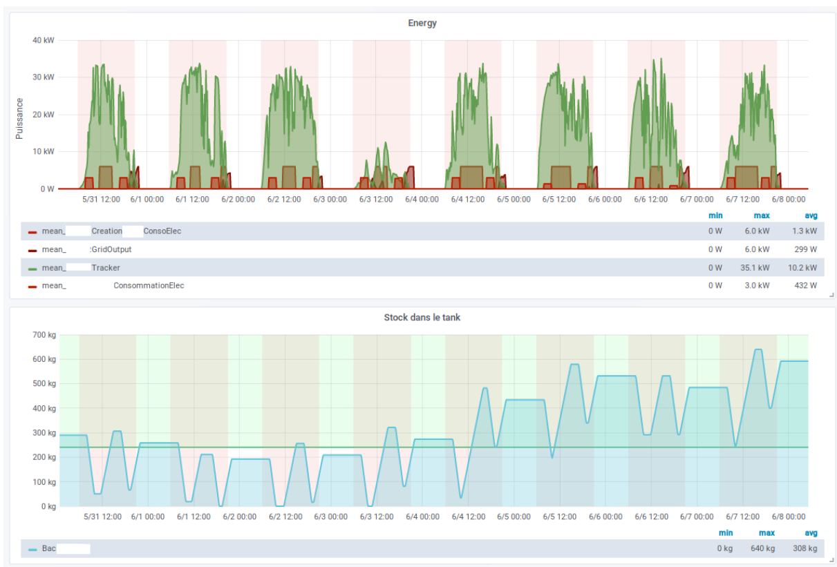
FIGURE 8.5 – Suivi dans la plateforme dédiée, le graphique en haut représente les flux d'énergie électrique et celui du bas l'état de charge du moyen de stockage au cours du temps. La production d'énergie est en vert, la consommation teinte de rouge. La ligne verte correspond à un seuil de sécurité que le système essaie de maintenir.
