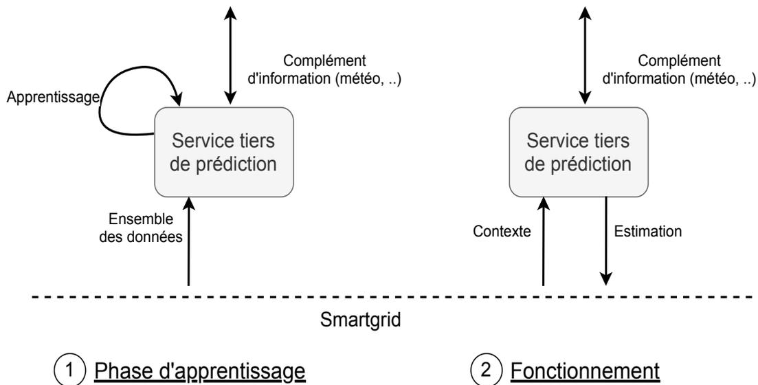
FIGURE 4.10 – Illustration d'utilisation d'un service d'apprentissage du point de vue d'un outil de gestion de l'énergie
