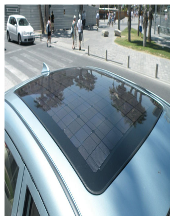
(b) Toit de voiture intégrant des cellules photovoltaïques
