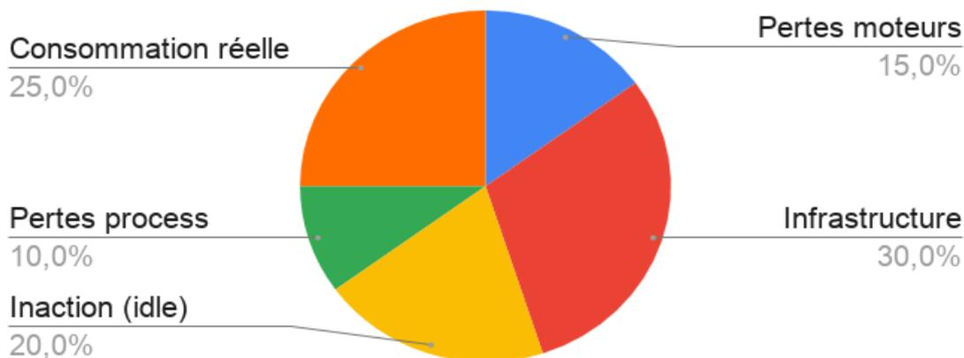
FIGURE 4.5 – Répartition de la consommation d'une machine-outil industrielle
