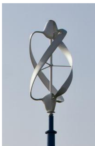
FIGURE 2.9 – Éolienne à axe vertical fabriquée par Noveol, de 3m de diamètre et produisant 6kW
