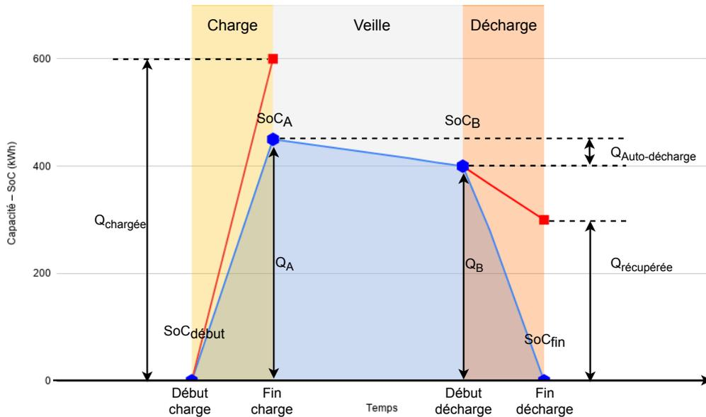
FIGURE 4.4 – Cycle de charge d'une batterie d'un état  $SoC_{début}$  à un état  $SoC_{fin}$  fondé sur [3]. La ligne bleue représente l'état de charge de la batterie en prenant en compte les pertes de charge et de décharge.
