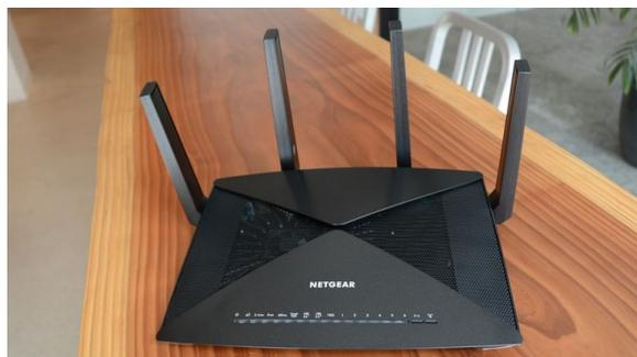
**Fig. 1.9.** Routeur Nighthawk X10 de Netgear fonctionnant à 2,4/5/60 GHz [91]
