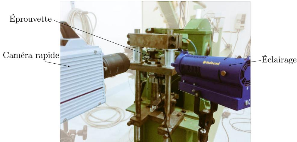
FIGURE 4.7 – Montage sur roue inertielle pour l’observation des champs de déformation à la surface des éprouvettes sollicitées en régime dynamique à température ambiante.
