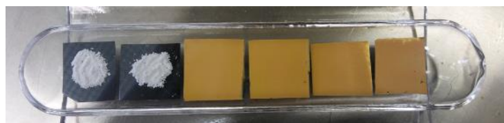
Figure 3.2 – Positionnement des échantillons dans la nacelle pour le traitement thermique en four tubulaire
