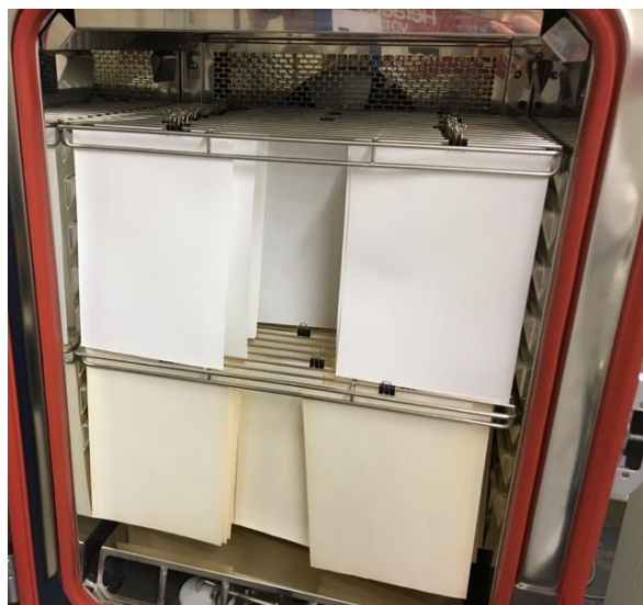
Figure M.1. Échantillons de papier disposés dans l'enceinte climatique WEISS WK3. En haut : papiers C1. En bas : papiers C3.
