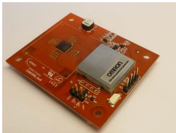
Figure 1.7 : Prototype d'un générateur électrostatique développé par Omron et Holst Center/Imec [22].
