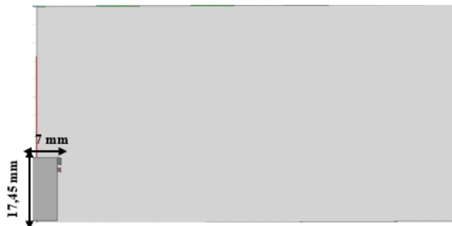
Figure 75. Excitation du mode 5 à 3,24 GHz avec une antenne PIFA
