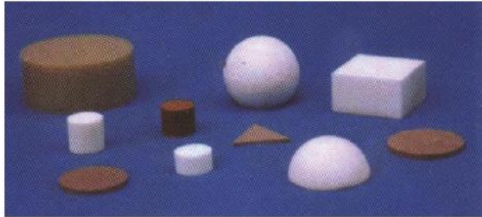
Figure 24. Diverses formes de résonateurs diélectriques
