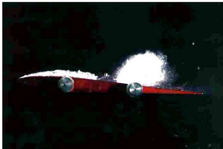
FIGURE 16.9 – Poche de cavitation avec lâcher de vapeur sur un profil (extrait de [1])
