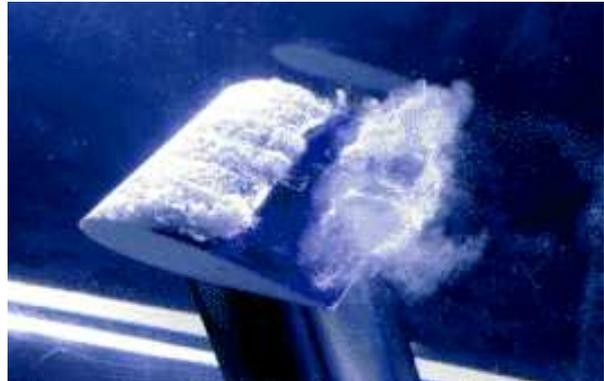
FIGURE 16.4 – Poche attachée sur un hydrofoil avec lâchés de vapeur (extrait de [1])
