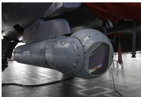
FIGURE 6.2 – Un pod multifonction Talios.
