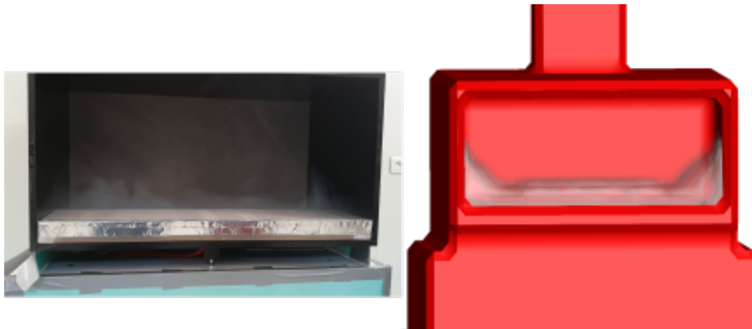
Figure V.24. Injection de polluant à l'intérieur de la sorbonne. Une photographie réelle est présentée à gauche tandis qu'une simulation numérique (maillage 192 \times 131 \times 102 ) de l'injection de polluant est présentée à droite. Sur la photographie de gauche, le plateau d'injection disposé sur le plan de travail de la sorbonne est visible (et par soucis de visibilité, l'extraction d'air est volontairement désactivée dans le but d'observer l'injection réelle de polluant).
