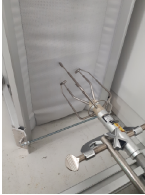
Figure V.9. Mesure de vitesses en un point situé en aval d'une des faces de la gaine diffusante via un anémomètre à ultrason.
