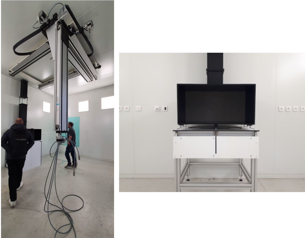
Figure V.2. Photographies de l'intérieur de l' Aerocab . La sorbonne de laboratoire modèle et le système de déplacement sont visibles. Les espaces vides apparents sous la sorbonne dans la photographie de droite sont calfeutrés, comme on peut l'apercevoir sur la photographie de gauche et ce afin de faciliter la modélisation des objets solides dans les simulations numériques.
