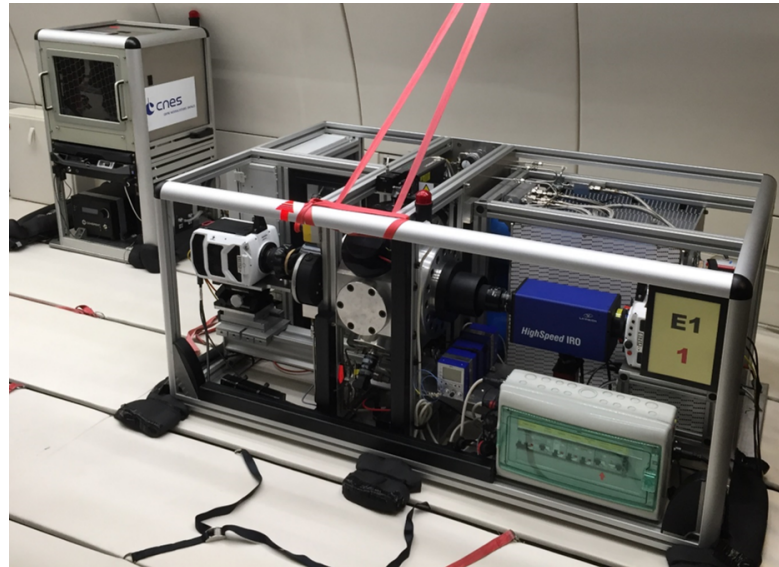
FIGURE 2.3 – Photographie du dispositif expérimental en configuration de vol à bord de l'A310 ZERO-G et en configuration chimiluminescence/ILIDS
