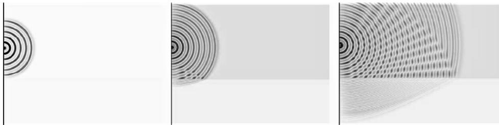
FIGURE 1.9 – Illustration en 2D de la réflexion d'une onde sur un sol absorbant, engendrant des interférences dans le milieu incident (issu de [Gauvreau, 2015](#)).
