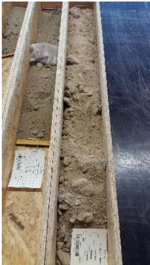
Figure 22: Exemple de carottes sédimentaires dans la série miocène sableuse du forage Bresse-1 de la Bresse méridionale. Le puits est non listé dans la Table 1 car il n'a pas fait l'objet d'analyse séquentielle.
