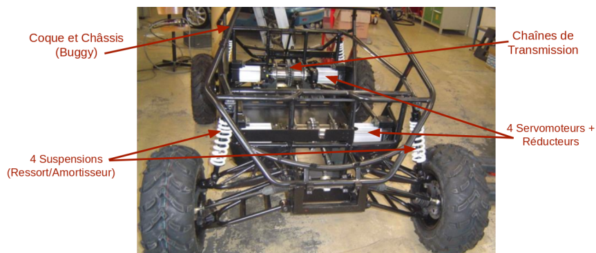
Figure A.4. “ SPIDO ”, véhicule électrique 4WS utilisé pour évaluer les algorithmes proposés.
