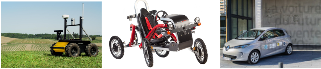
Figure 1.1. Quelques exemples de robots mobiles tout-terrain. De gauche à droite : Husky robot UGV, SWINCAR e-Spider, véhicule intelligent APACHÉ (laboratoire Heudiasyc).
