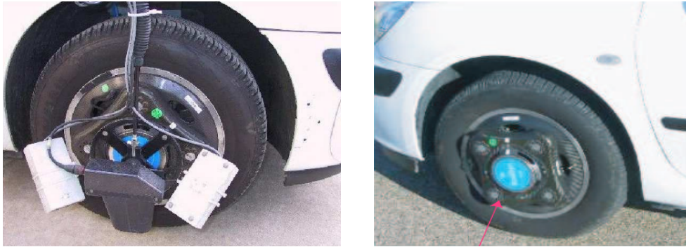
Figure 1.2. Exemples des méthodes de mesure directe des paramètres d'état du véhicule. [Gauche] Capteur pour la mesure de la vitesse latérale développés par l'ENSEEIH. [Droite] Capteur de force installé dans la roue Doumiati et al. (2010).
