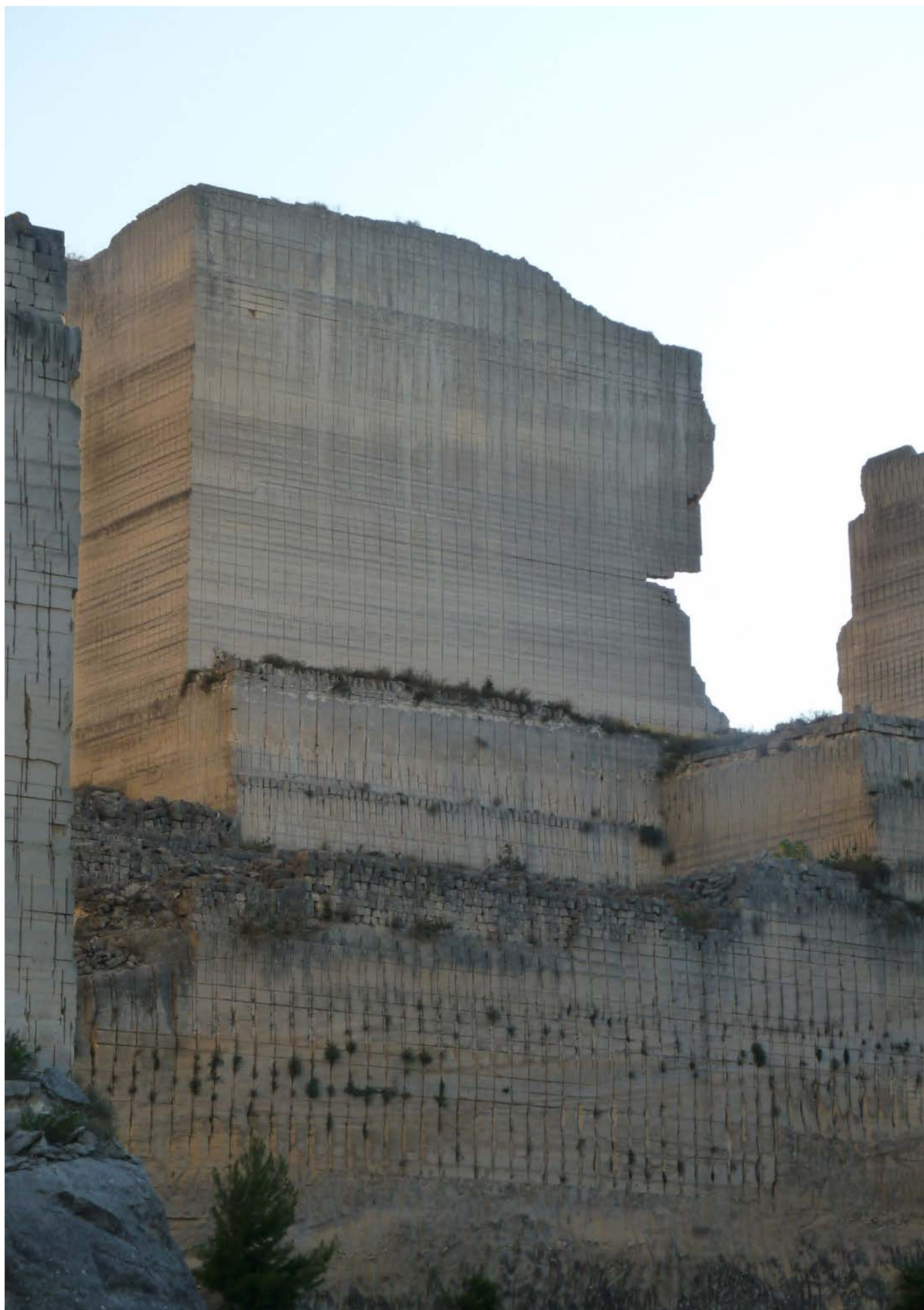
Fig 2. Traces de l'extraction de la pierre calcaire dans la Cava Paradiso Source : photographie de M.Rotolo (octobre 2011)
